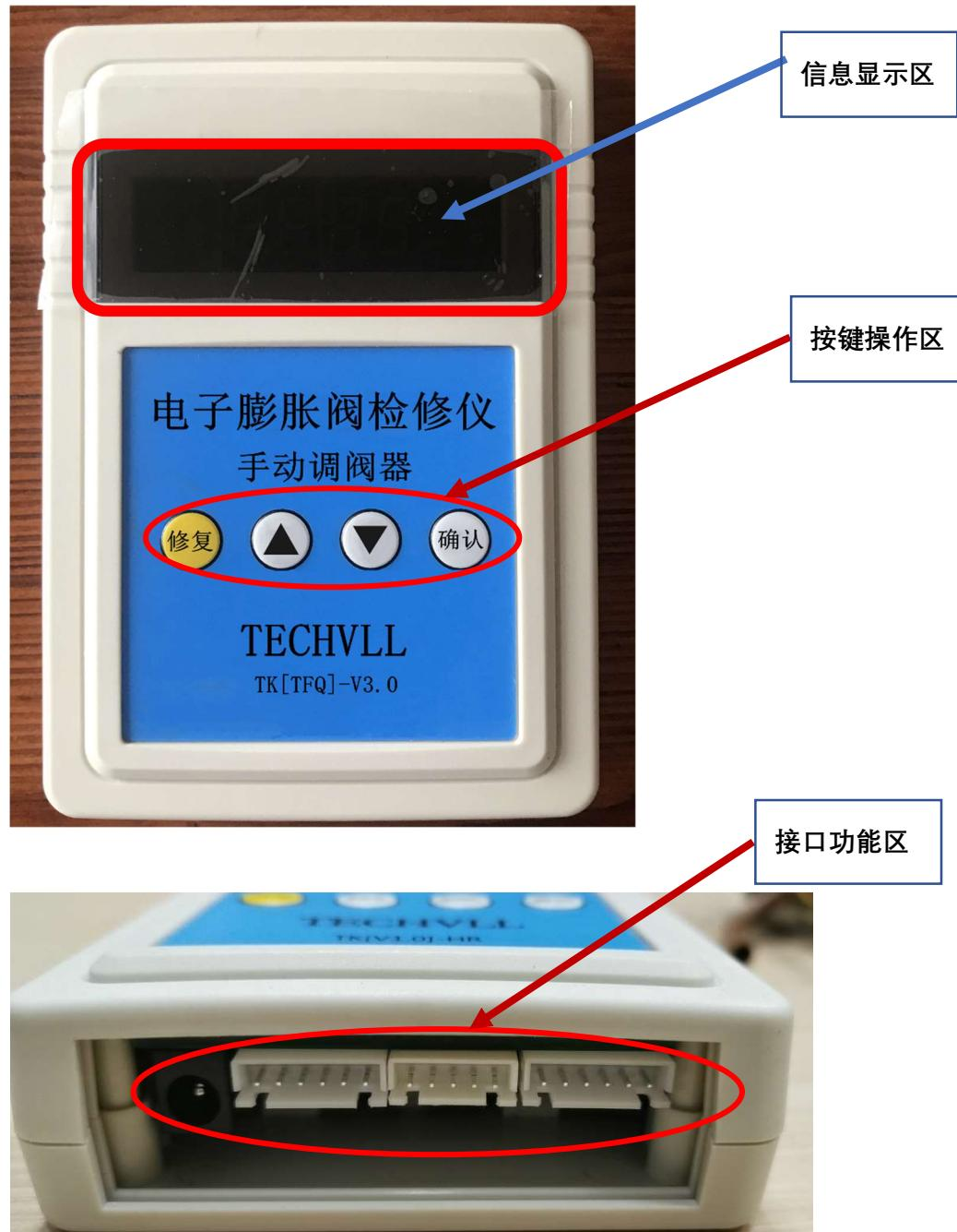
图 5、检修仪功能结构示意图
