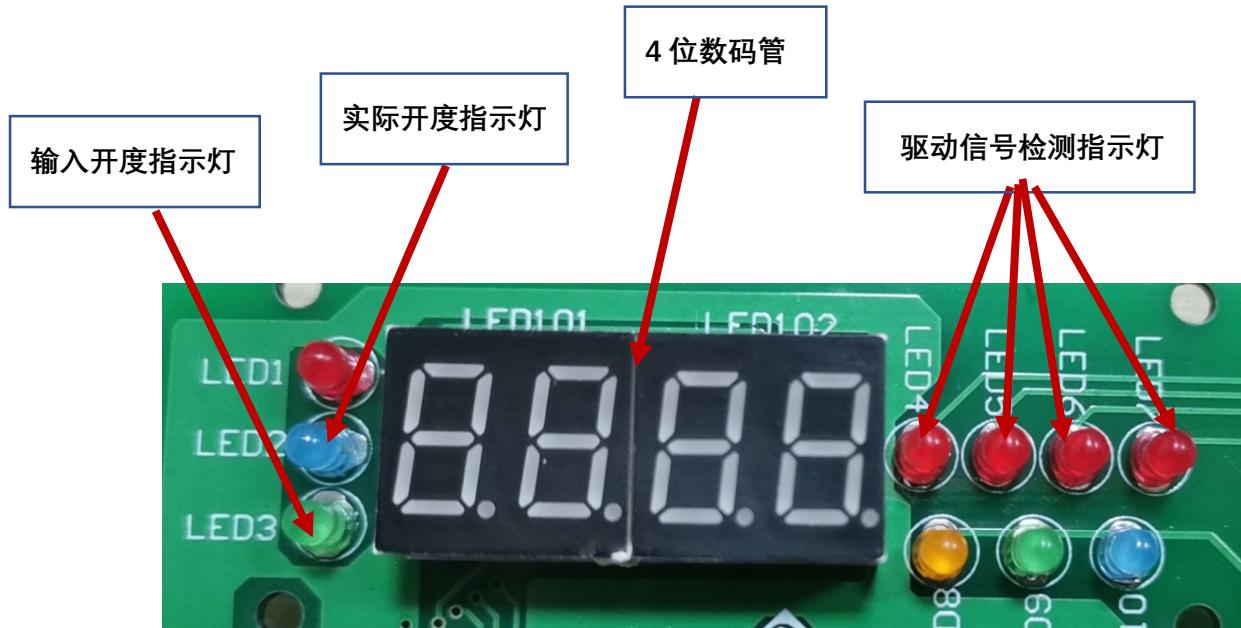
图 6、信息显示区内部结构图
